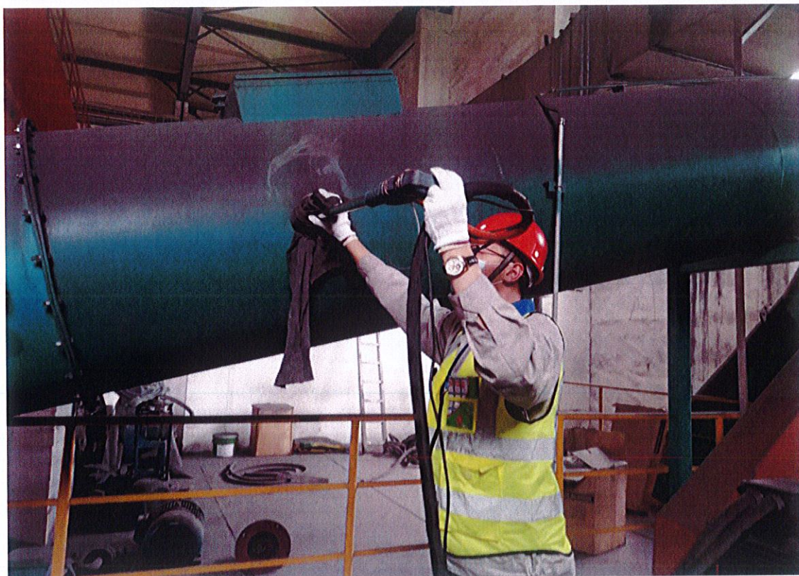
附图 1 烘包间排气筒出口废气采样
